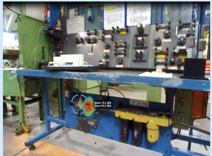
Se marca la fuente de ruido en ese puesto de trabajo, el ruido de la salida de aire comprimido (valor Beam) contribuye fuertemente al nivel general de ruido (valor Omni).
